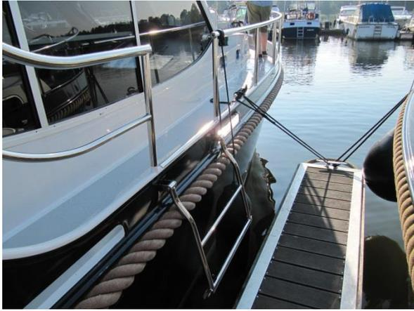
Der Teil der Reling, in dem sich der Seitenausstieg befindet, kann nach außen heruntergeklappt und dann als Leiter genutzt werden.
